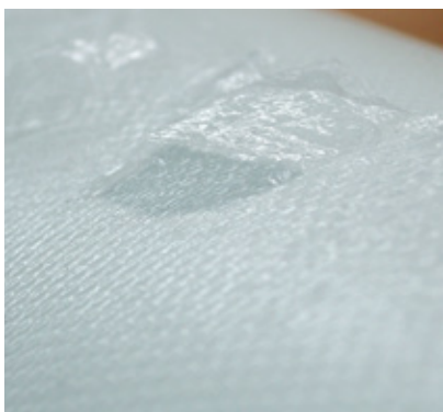
Zdjęcie 1: „Efekt rozwarstwiania” spowodowany zbyt grubą warstwą lakieru i niedostateczną spójnością warstw.
