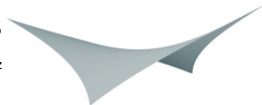
Rysunek 1: Paraboloida hiperboliczna
