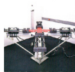
Próba wytrzymałości dwukierunkowej
