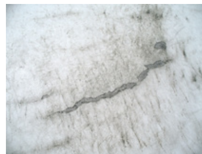
Zdjęcie 3: Skutki zbyt dużej sztywności tkaniny z powodu grubej warstwy lakieru. Pęknięcia lakieru mogą czasami sięgać aż do powłoki PVC.
