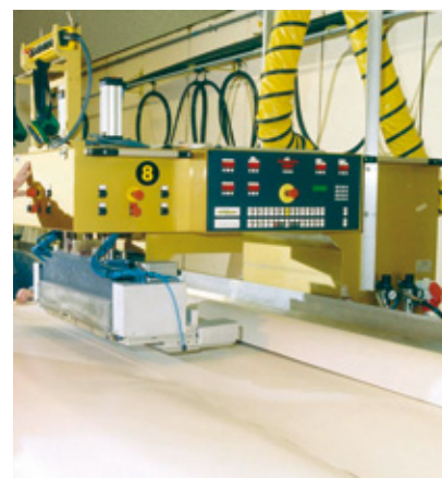
Zgrzewanie prądem o wysokiej częstotliwości
